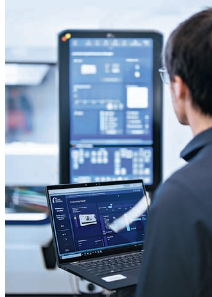
配备 C.O.R.E. 系统的机床具有最先进的触摸显示屏, 而且可以通过 umati 与第三方设备通信
