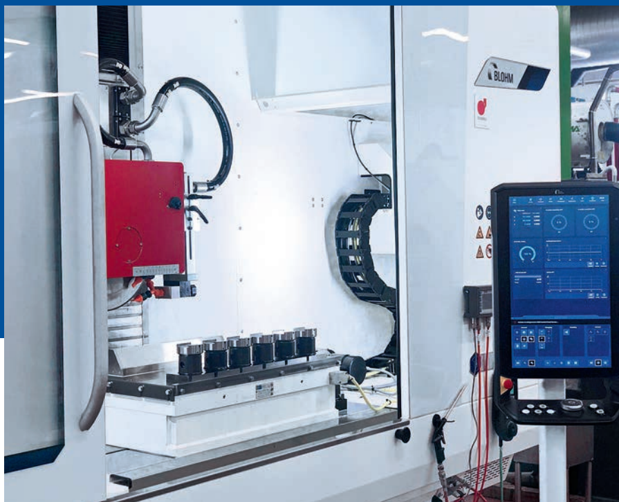
在带有 C.O.R.E. 触摸屏的 PLANOMAT XT 408 上制造模块化精密刀具夹持器
