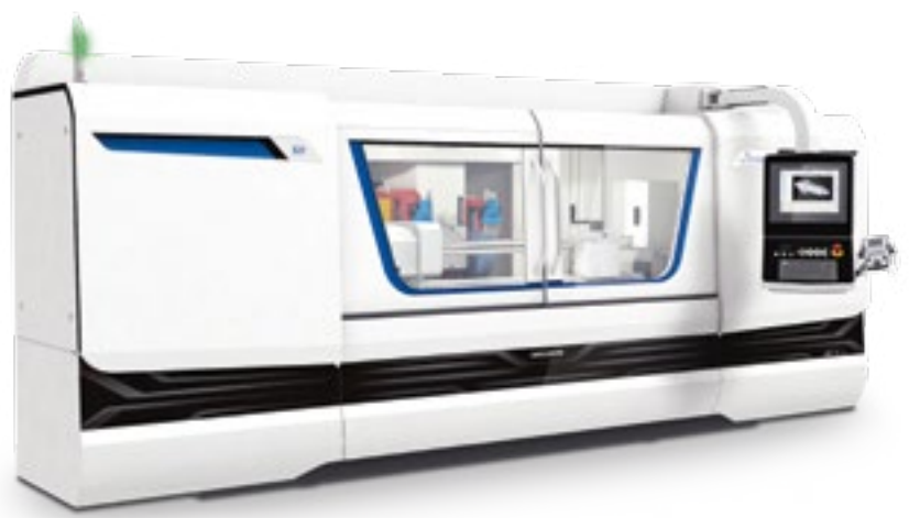
STUDER S31 适于刀具部件制造和各种航空航天部件加工应用
