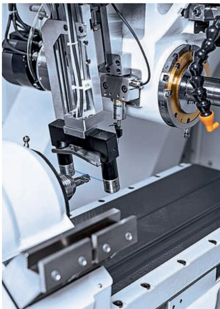
WALTER 刀具磨床中的激光轮廓检测测量系统
