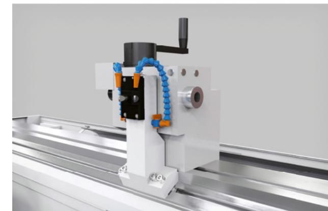
在固定工作台的 T 型槽中安装修整器支架
