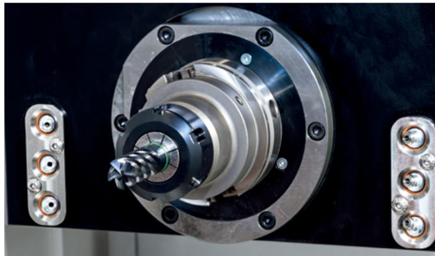
磨削支撑两侧可以选配冷却液喷嘴用于钻削（选项）和铣削（选项），同时可以选配主轴中心出水。
