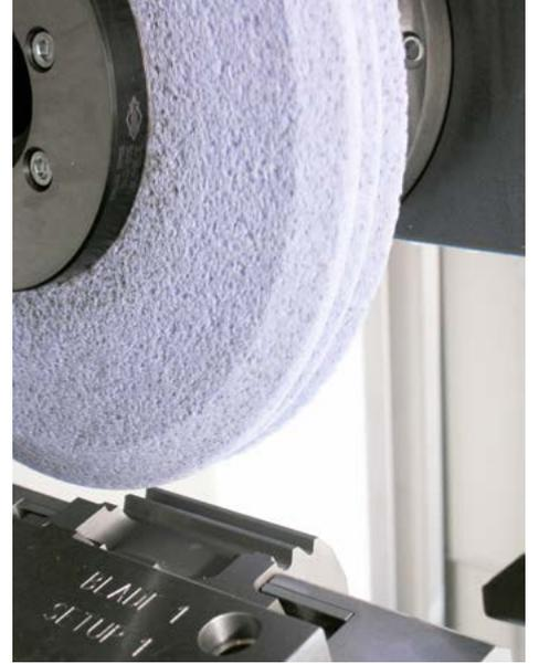
采用MFP50磨削导向和工作叶片具有很少的停工时间，结合24工位全自动砂轮更换装置和顶置式连续修整可在一次装夹下完成工件多个表面轮廓的加工且加工尺寸十分稳定。
