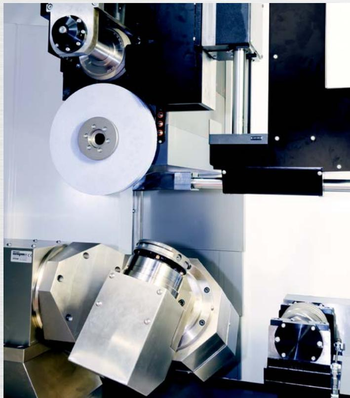
美盖勒 MFP 50磨削中心结构紧凑，将高效和柔性加工结合在一起。作为一款带连续修整磨削功能的五轴或六轴磨削中心，MFP 50在加工复杂难加工的零件时，表现出了优异的性能和能力。智慧的设计帮助客户将产品制造质量、加工安全性和低成本高效率生产提升到新的水平。
